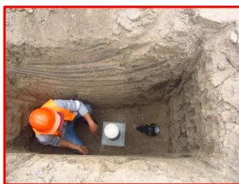
Ensayo de densidad de campo efectuado en la calicata C-6
